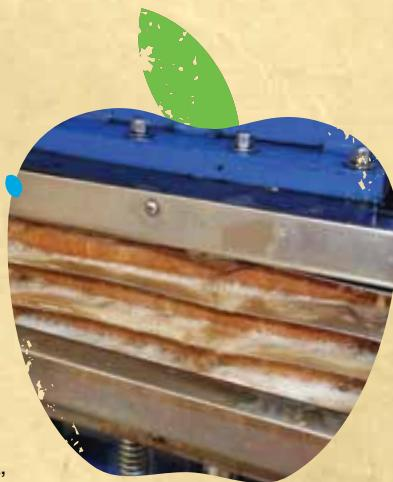
Sljedeći korak je izrada „pogača“ odnosno punjenje četvrtaste tkanine, specifične gustoće, izribanim jabukama. Slažu se jedna na drugu poput katova koje razdvaja metalna perforirana prepreka. Kad se složi 5 redova/katova, cijeli sklop se stavlja pod prešu. Pritiskom jačine čak 25 tona, preša hladno cijedi prirodni sok u kante koji se potom izljeva u inox bačvu zapremine do 400 litara.
